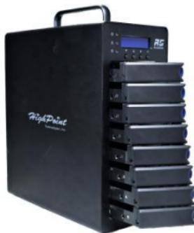
2. 小心地将3.5英寸或2.5英寸磁盘插入每个磁盘托盘，并用提供的安装螺钉固定。
