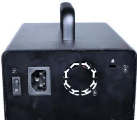
5. 当RocketStor6618V通过Thunderbolt™电缆连接到主机系统时，RocketStor6618V与主机系统同时断电。因此，首先开机的主机系统RocketStor6618V将自动开机。
